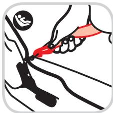
**3. Hook LATCH to Vehicle LATCH Anchor**
